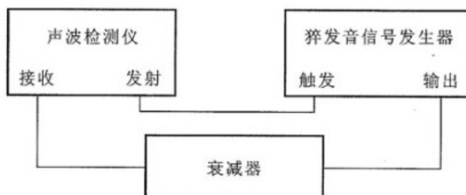
图 3 幅值测量级线性的检定装置示意图
